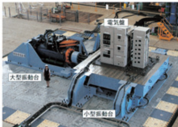
▲振動台による実証試験の例
