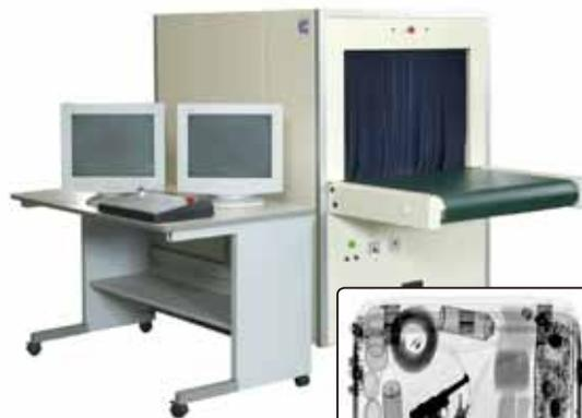
空港などで利用されている手荷物用X線検査装置
